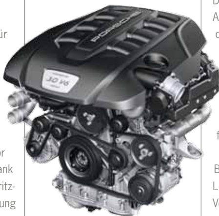
DER V6-MONOTURBO DIESELMOTOR wurde neu entwickelt und verfügt erstmals über einen wassergekühlten Turbolader mit größerem Durchmesser.
